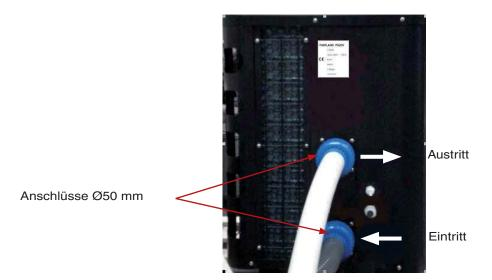
Diese Anschlüsse werden mit einem Filter-Bypasskreislauf verbunden, der mit zwei Absperrventilen ausgestattet ist (eines am Eintritt und eines am Austritt), um die Anlage zu isolieren falls sie bewegt werden muss. Für die Steuerung der Durchflussrate sollte in der Hauptleitung - zwischen den beiden Abzweigungspunkten des Bypasses - ein drittes Ventil installiert werden (s. S. 12 - Inbetriebnahme der Wärmepumpe).
