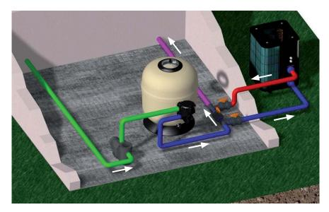
Die Rohre, Ventile und Anschlüsse, aus denen der Bypasskreislauf besteht, sollten aus Hochdruck-PVC (10 bar) zum Kleben, Durchmesser 50, bestehen. Der Kleber muss vollständig trocken sein, bevor die Leitungen von Wasser durchflossen werden.
